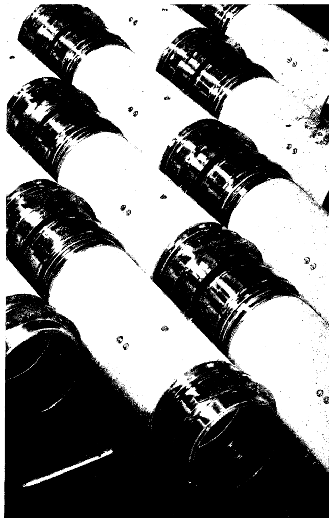
Electrodes Pick-up réalisées pour le Booster Service SI. - Métallisation intérieure, avec dorure. Scellement étanche céramique-titane-inox, et assemblage des embouts inox sur inox par bombardement électronique.
